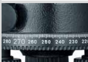
Horisontalkreds med endeløs sidefinindstilling til nøjagtig indsigtning.
