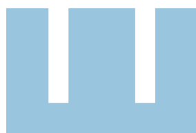
SKÆREBREDDE Med 2 diamantskiver 7 - 30 mm i bredden
